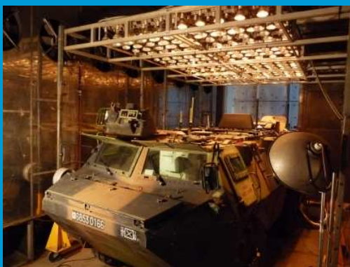
Véhicule blindé en phase d'essai climatique Armoured vehicle within the climatic room
