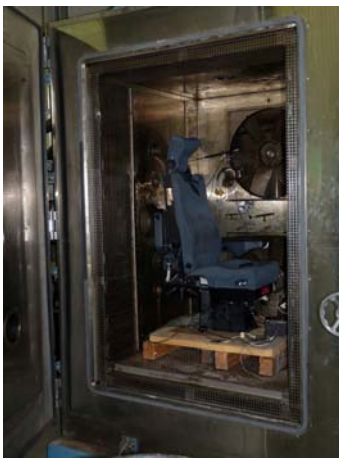
Siège d'avion en phase de qualification thermique Aircraft seat into a test climatic room
