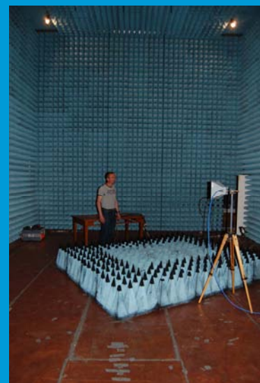
Chambre semi-anéchoïque de 500m 3 500m 3 ECM room
